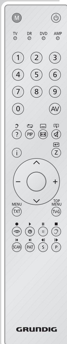
1 Teletekst moduna geçmek için »TXT« düğmesine basın.
