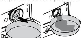
Mettez un grand bac devant le filtre pour recueillir l'eau du filtre. Desserrez le filtre de la pompe (dans le sens inverse des aiguilles d'une montre) jusqu'à ce que l'eau commence à y couler. Remplissez l'eau dans le bac que vous avez placé devant le filtre. Gardez toujours un morceau de chiffon pour absorber toute eau déversée. Lorsque l'eau contenue dans la machine est finie, sortez le filtre complètement en le tournant.
