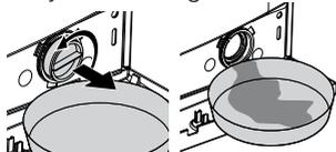
Mettez un grand bac devant le filtre pour recueillir l'eau du filtre. Desserrez le filtre de la pompe (dans le sens inverse des aiguilles d'une montre) jusqu'à ce que l'eau commence à y couler. Remplissez l'eau dans le bac que vous avez placé devant le filtre.
