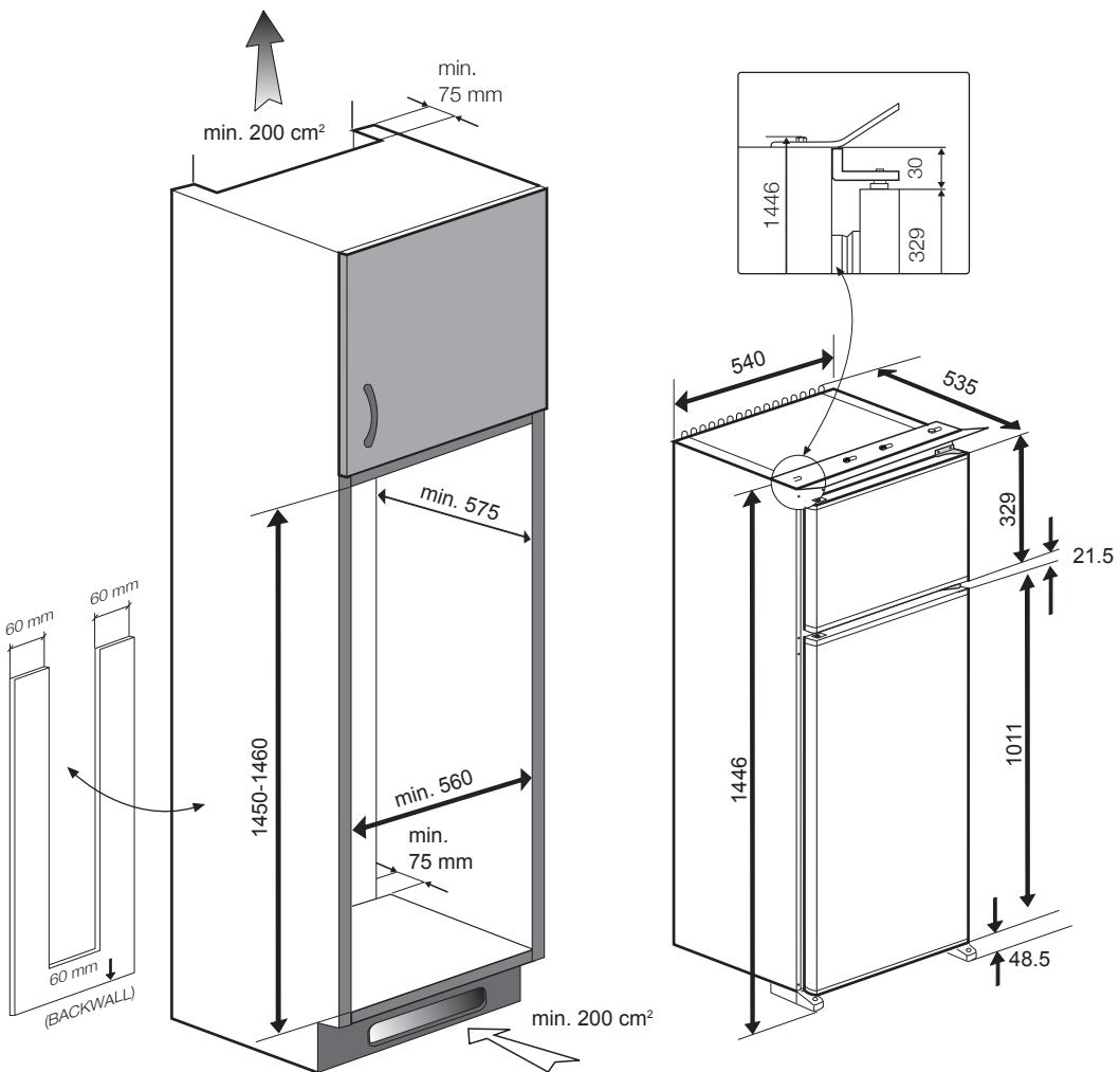
Enerji tasarrufu için buzdolabı arkasında yeterli hava sirkülasyonu sağlanmalıdır. Bu amaçla buzdolabının içine yerleştirileceği ahşap kabinin arka yüzeyi kapatılmamalıdır.
