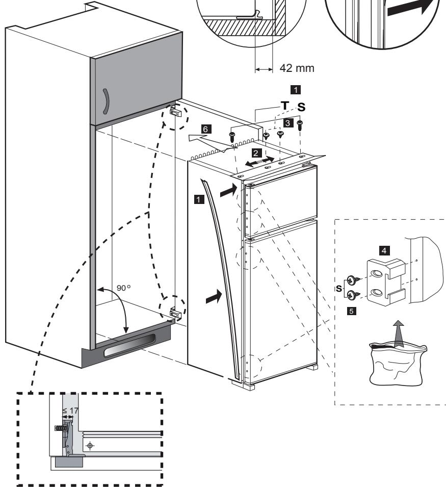
**Not:** 2-3 numara ile gösterilen montaj adımında üst bağlantı plastikini kaydırabilmek için bağlantıların yapıldığı vidaları tam sıkmayın.
