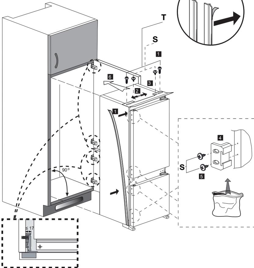
**Not:** 2-3 numara ile gösterilen montaj adiminda üst bağlantı plastiğini kaydırabilmek için bağlantının yapıldığı vidaları tam sıkmayınız.
