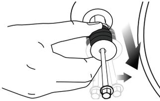
3. Setzen Sie die Kunststoffabdeckungen (diese finden Sie in der Tüte mit der Bedienungsanleitung) in die Löcher an der Rückwand ein. (P)
