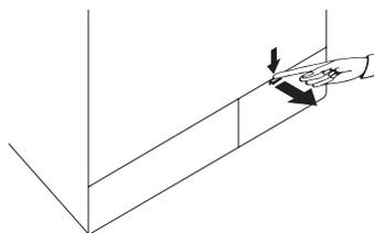
Bei einer einteiligen Filterkappe öffnen Sie die Kappe, indem Sie sie an beiden Seiten nach oben ziehen.
