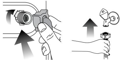
3. Nach dem Anschluss der Schläuche öffnen Sie die Wasserzuläufe (Hähne) komplett und überzeugen sich
