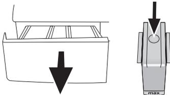
1. Drücken Sie die runde Markierung im Weichspülerfach hinab und ziehen Sie die Schublade zu sich hin, bis Sie sie aus der Maschine nehmen können.
