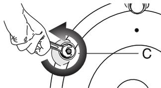
2. Entfernen Sie die Transportsicherungen, indem Sie diese vorsichtig herausdrehen.
