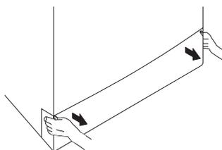
**i** Die Filterabdeckung lässt sich entfernen, indem Sie einen dünnen Gegenstand mit Kunststoffspitze zur Hand nehmen und die Abdeckung durch die Öffnung oberhalb der Filterabdeckung etwas nach unten drücken. Versuchen Sie nicht, die Abdeckung mit Metallgegenständen zu lösen.
