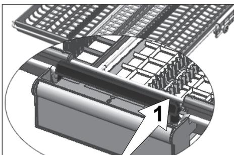
In Modellen mit partieller Bewegungsfunktion können Sie die zentrale Ablage des Korbs durch Drücken der Stange (1) am Griff auf die unterste Position einstellen. Damit wird das System freigegeben. Dadurch können die rechten und linken Ablagen als bewegliche Teile genutzt werden. Der durch die seitlichen Ablagen geschaffene Platz ermöglicht die Beladung des oberen Korbs mit langen Gegenständen.
