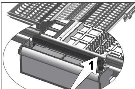
In Modellen mit partieller Bewegungsfunktion können Sie die zentrale Ablage des Korbs durch Drücken der Stange (1) am Griff auf die unterste Position einstellen. Damit wird das System freigegeben. Dadurch können die rechten und linken Ablagen als bewegliche Teile genutzt werden.
