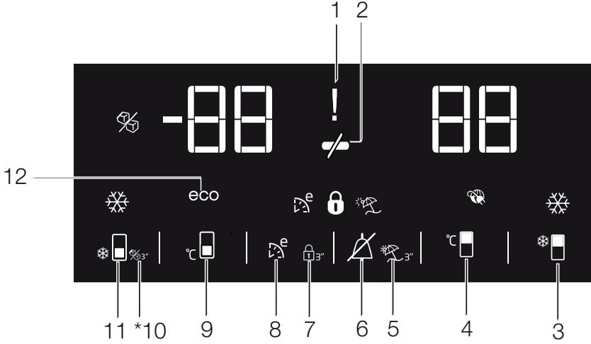
1. انقطاع الكهرباء/مؤشر درجة الحرارة المرتفعة / التحذير بوقوع خطأ
