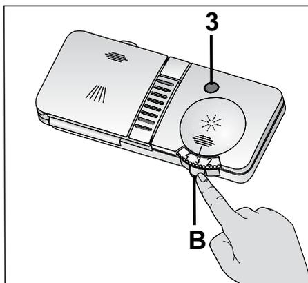
2. Remplissez le réservoir jusqu'au niveau "MAX".
