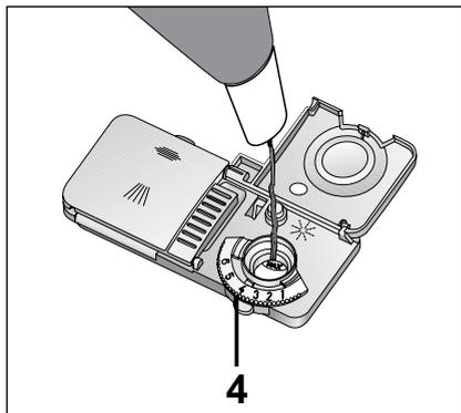
4. Tournez le régleur de quantité de produit de rinçage à un niveau entre 1 et 6 (4). S'il y des taches sur les couverts après le lavage, le niveau doit être augmenté et s'il y a une trace bleue après l'avoir essuyé avec la main, il doit être diminué. Il est réglé sur 4 comme réglage d'usine.
