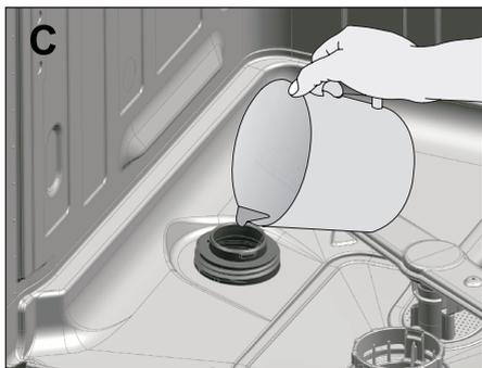
3. Remplissez le réservoir de sel avec le sel en utilisant l'entonnoir à sel (D). Pour accélérer la dissolution du sel dans l'eau, remuez-le à l'aide d'une cuillère.
