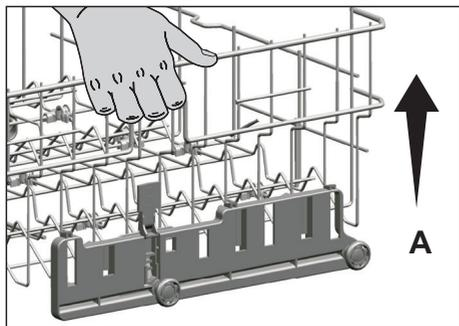
Veillez à ce que le mécanisme d'ajustement de la hauteur des deux côtés du panier chargé soit réglé au même niveau (bas ou haut).
