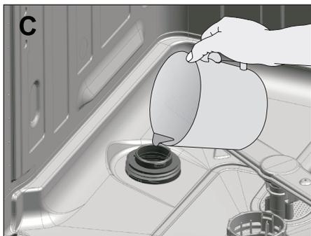
3. Remplissez le réservoir de sel avec le sel en utilisant l'entonnoir à sel (D). Pour accélérer la dissolution du sel dans l'eau, remuez-le à l'aide d'une cuillère.
