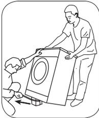
Kantel de machine naar achteren om de verpakkingsversteving te verwijderen. Verwijder de verpakkingsversteving door aan het lint te trekken. Voer deze handeling niet alleen uit.
