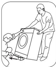
Incline a máquina para trás para retirar o reforço da embalagem. Retire o reforço da embalagem puxando pela fita. Não realize este procedimento por conta própria.
