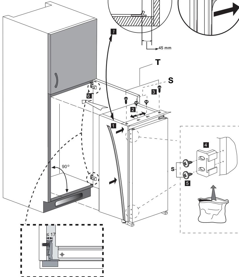
**Not:** 2-3 numara ile gösterilen montaj adımında üst bağlantı plastikini kaydırabilmek için bağlantının yapıldığı vidaları tam sıkmayın.
