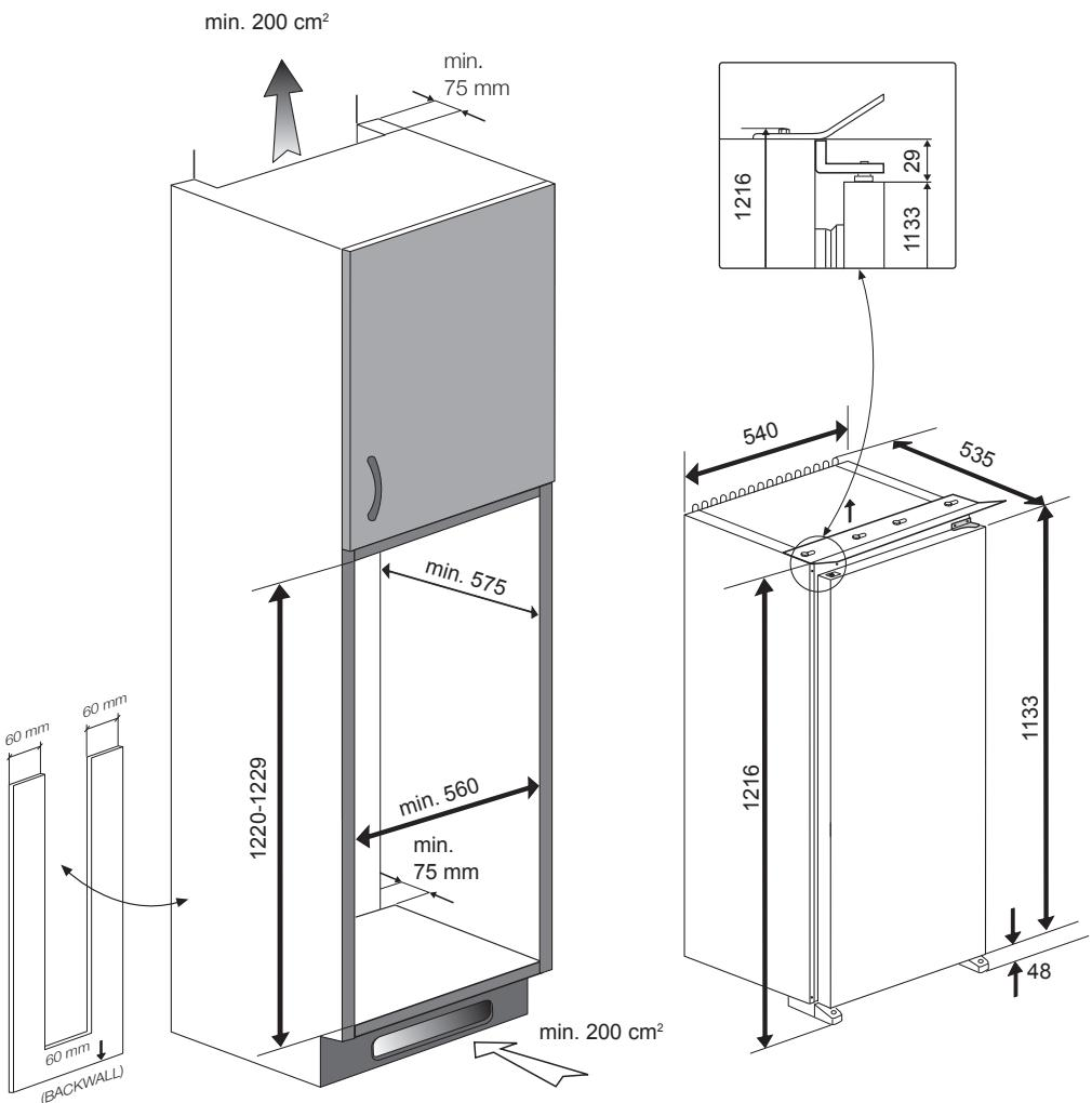
Enerji tasarrufu için buzdolabı arkasında yeterli hava sirkülasyonu sağlanmalıdır. Bu amaçla buzdolabının içine yerleştirileceği ahşap kabinin arka yüzeyi kapatılmamalıdır.
