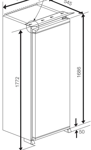
Enerji tasarrufu için buzdolabı arkasında yeterli hava sirkülasyonu sağlanmalıdır. Bu amaçla buzdolabının içine yerleştirileceği ahşap kabının arka yüzeyi kapatılmamalıdır.
