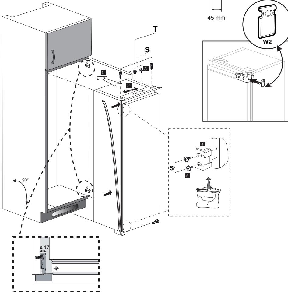
**Not:** 2-3 numara ile gösterilen montaj adımında üst bağlantı plastikini kaydırılabilmek için bağlantının yapıldığı vidaları tam sıkmayın.
