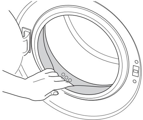
Falls die in der Abbildung gezeigten Öffnungen in der Gummidichtung verstopft sein sollten, entfernen Sie die Verstopfung mit einem Zahnstocher.
