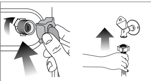
Nach dem Anschluss der Schläuche öffnen Sie die Wasserzulaufe (Hähne) komplett und überzeugen sich davon, dass kein Wasser an den Anschlussstellen austritt. Falls Wasser austreten sollte, drehen Sie den Hahn zu und lösen anschließend die Mutter. Überprüfen Sie die Dichtung und ziehen Sie die Mutter anschließend wieder gut an. Um ein Auslaufen von Wasser und daraus entstehende Wasserschäden zu vermeiden, halten Sie die Wasserhähne geschlossen, wenn Sie die Maschine nicht benutzen.
