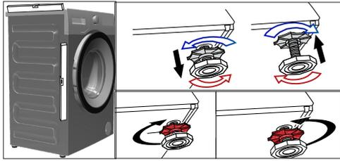
1. Lösen Sie die Kontermuttern an den Füßen von Hand.
