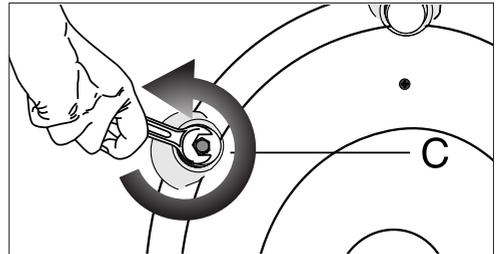
2. Entfernen Sie die Transportsicherungen, indem Sie diese vorsichtig herausdrehen.
