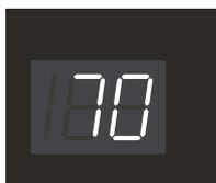
Muestra el tiempo restante de lavado. Muestra el tiempo de inicio diferido reservado. Muestra el estado de error si se produce un problema en la lavadora para que usted puede tomar medidas.
