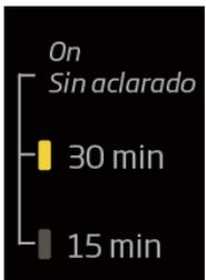
Agua en la cuba será seleccionable de 'secar al aire "función de LED Button. 2 Botones estarán juntos durante la selección de mantener en remojo. Después del último enjuague, el agua no va a drenar. Se mantiene en la máquina. pausa de la máquina en el paso, y LED1 y LED2 siempre parpadean. Cuando el cliente quiere para drenar el agua, tienen que presionar el botón de inicio de pausa de nuevo para continuar con el tiempo de giro predeterminado.
