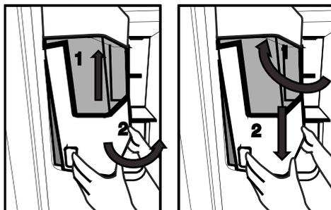
Poussez fermement vers le bas, jusqu'à ce qu'il n'y ait plus d'espace entre le réservoir et le plastique de la porte. (Figure 2)
