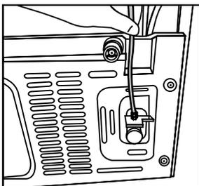
3. Serrez le joint à la main pour fixer l'adaptateur de l'embout du tuyau. Vous pouvez également serrer le joint avec une clé serre-tube ou des pinces.
