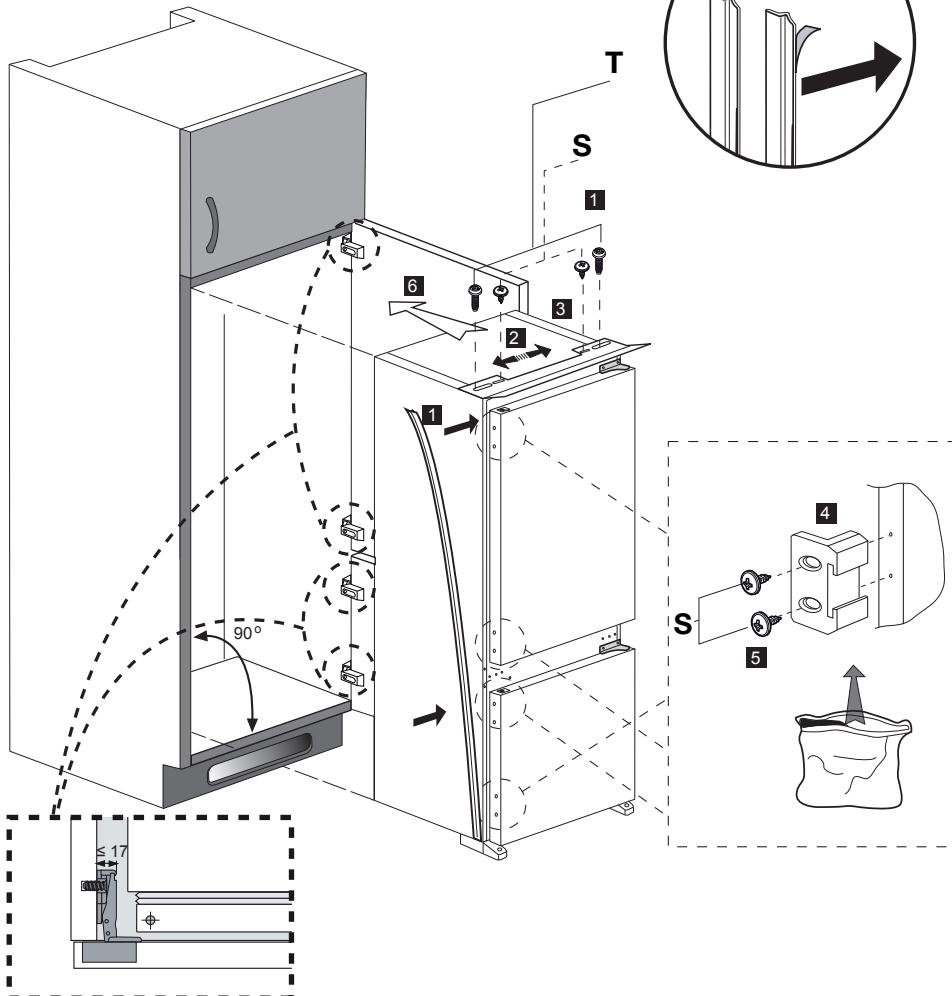
**Not:** 2-3 numara ile gösterilen montaj adımında üst bağlantı plastikini kaydırabilmek için bağlantının yapıldığı vidaları tam sıkmayın.
