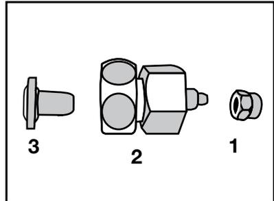
2. Raccordez l'adaptateur du robinet à la vanne d'arrêt du réseau d'approvisionnement d'eau.
