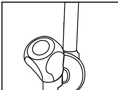
4. Fixez le tuyau d'eau en le tirant du dessus du filtre jusqu'à l'adaptateur de raccordement d'eau du réfrigérateur (voir Section 3.6).
