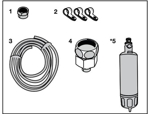
1. موصل (1 قطعة): يستخدم لتوصيل خرطوم الماء بظهر الجهاز.
