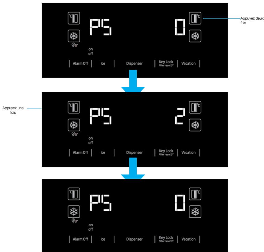
« À l'affichage de l'écran PS, arrêtez le réfrigérateur et allumez-le à nouveau. De cette façon, le compteur de filtre s'active. Le voyant d'avertissement LED du filtre s'active sur l'écran pendant 12 jours. Après avoir remplacé le filtre par un nouveau, appuyez sur le bouton Verrouillage de touche pendant 3 secondes pour permettre au compteur de filtre de lancer le compte à rebours de 12 jours.
