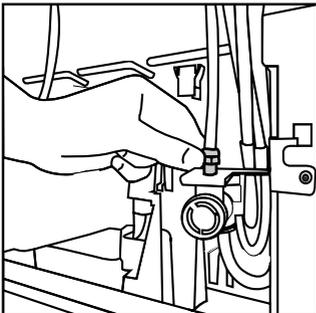
4. Raccordez l'autre extrémité du tuyau au réseau d'approvisionnement d'eau (voir Section 3.7), à la bonbonne ou à la pompe à eau (voir Section 3.8).
