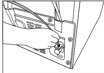
2. Raccordez l'autre extrémité du tuyau d'eau à la pompe à eau en poussant le tuyau à l'intérieur de l'orifice d'entrée de la pompe.
