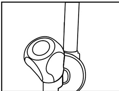
2. Localisez l'endroit de fixation du filtre externe. Fixez les accessoires de raccordement du filtre (5) au mur.
