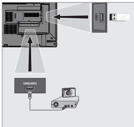
1 Televizyonun üzerindeki **USB(HDD)** USB arayüzü ile harici cihazın üzerindeki ilgili veri çıkışını (harici sabit disk, dijital kamيرا, kart okuyucu veya MP3 oynatıcı) bir USB kablosu ile bağlayın;
