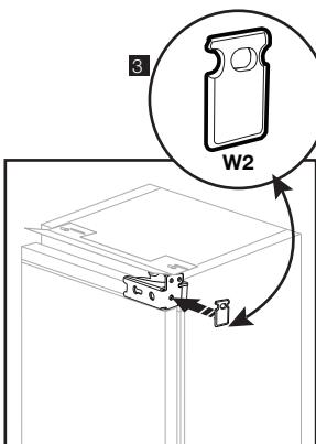
**Not:** 2-3 numara ile gösterilen montaj adımında üst bağlantı plastikini kaydırılabilmek için bağlantının yapıldığı vidaları tam sıkmayın.
